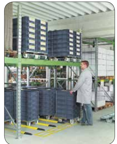
Dal lato B dello scaffale i Dolly vengono ripristinati nelle corsie FIFO On the B side of the shelf the dollies are restored into the FIFO lanes
