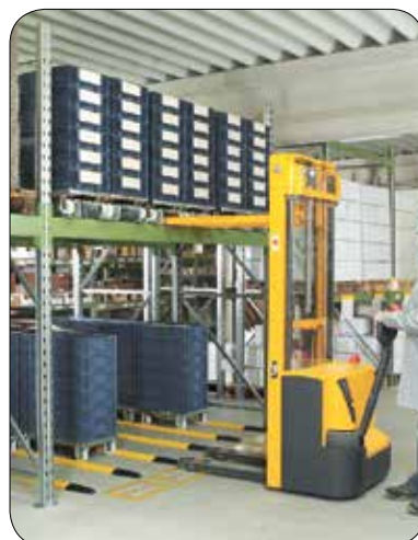
Dal lato B dello scaffale i Dolly vengono ripristinati nelle corsie FIFO On the B side of the shelf the dollies are restored into the FIFO lanes
