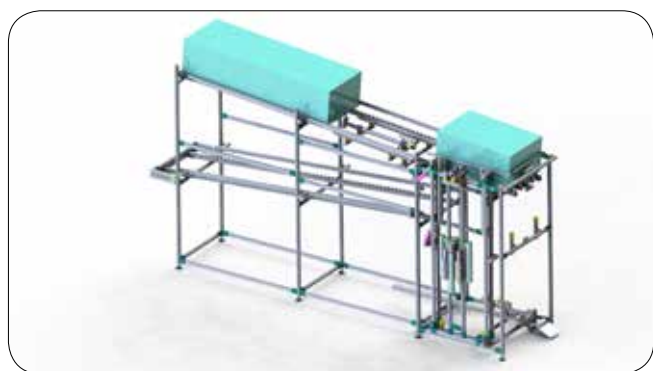
Sistema Karakuri a pedale con singolarizzazione del materiale /Karakuri system with pedal for material singularization
