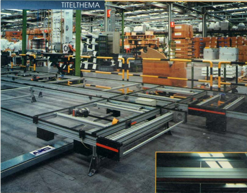
Der Größe des Transportguts genügen spezielle Werkstückträger; hier Hub-Quereinheit der Transferlinie mit einer Duschkabine in der Montagestation, oben links.
