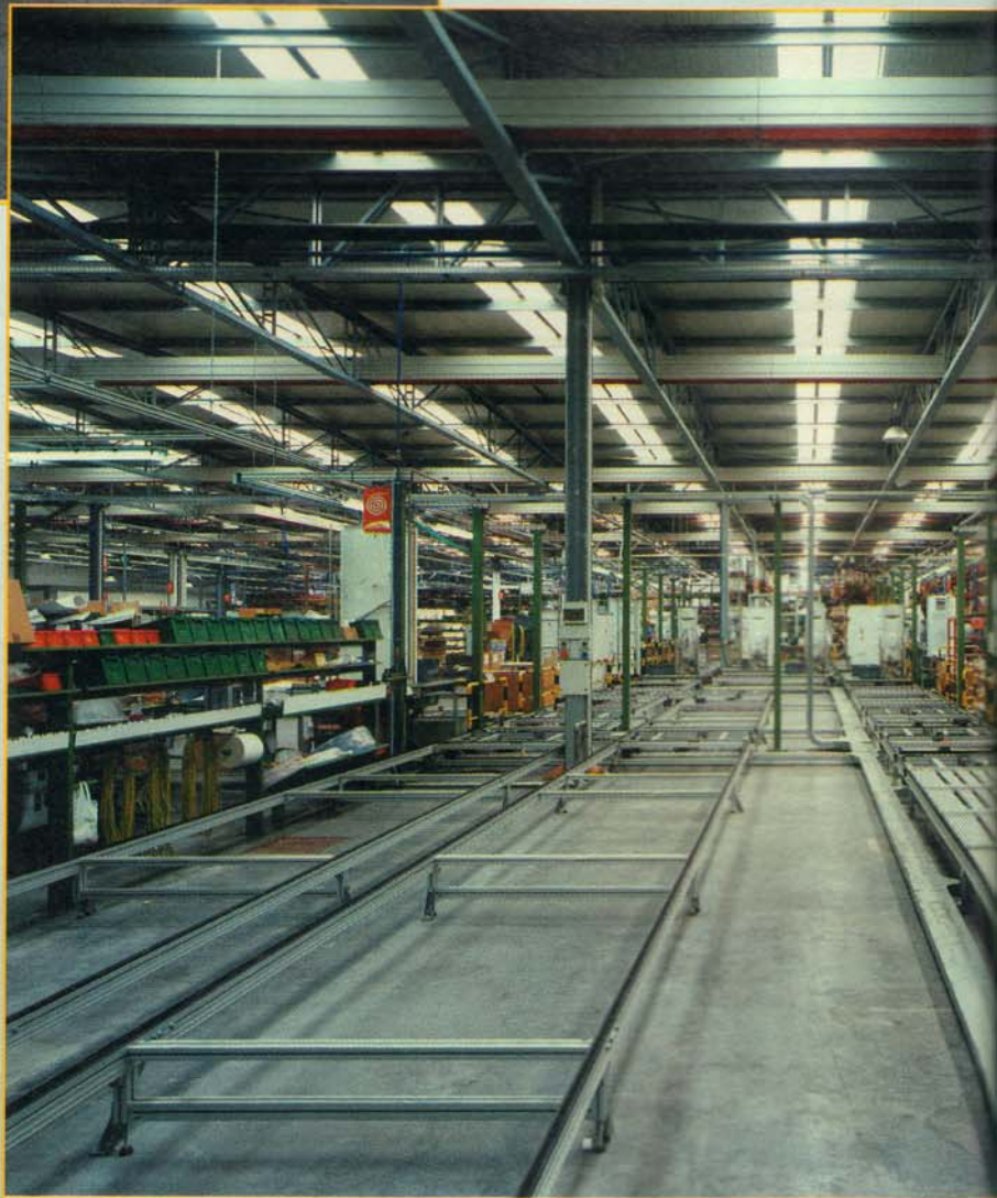
Der Größe des Transportguts genügen spezielle Werkstückträger; hier Hub-Quereinheit der Transferlinie mit einer Duschkabine in der Montagestation, oben links.
