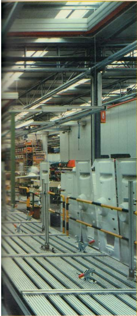
Ausweitung auf 30.000 m 2 Fertigungsfläche: hier die Teilansicht der etwa 200 m langen Transferlinie für die Duschkabinenmontage
